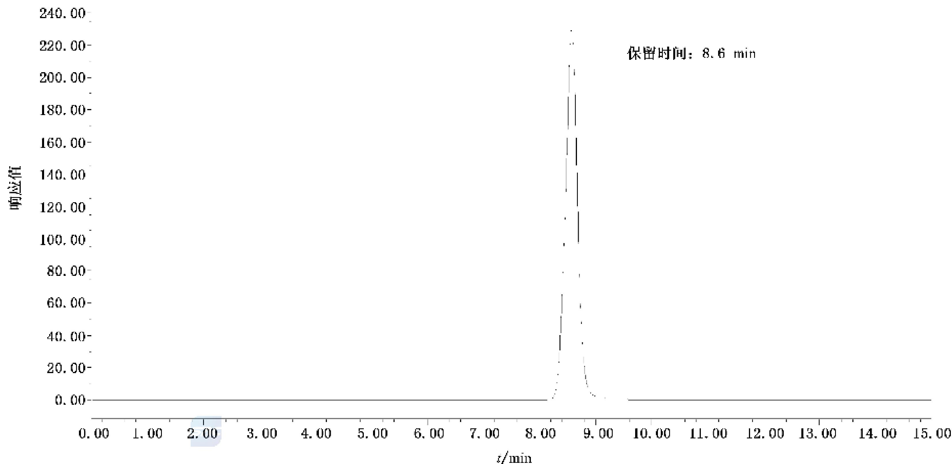
图 A. 1 0.20  $\mu\text{g}/\text{mL}$  丙二醛硫代巴比妥酸复合物色谱图
